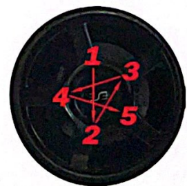
7a. Proper Lug Tightening: Cross Pattern
