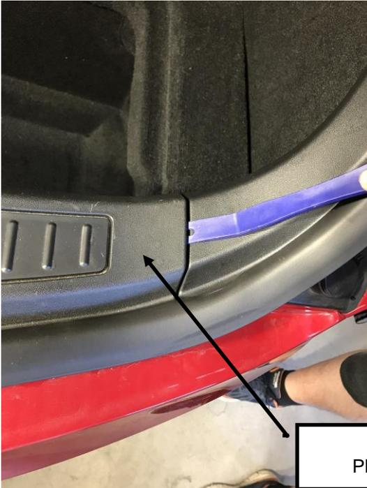
Hebeln Sie die Plastikverkleidung ab
