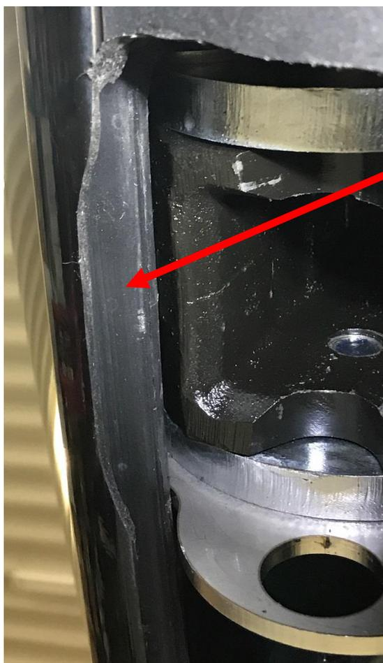
Den kleinen Ausschnitt nur so groß machen, dass die Klappe kurz darüber einrastet. Sie soll nicht im oberen Teil des Kupplungshalters einrasten
