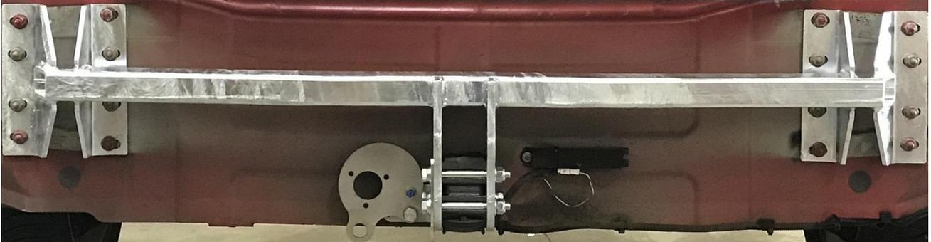
Setzen Sie den Aufnahmeblock des Kugelkopfes zwischen die beiden 10mm Aufnahmeplatten des
