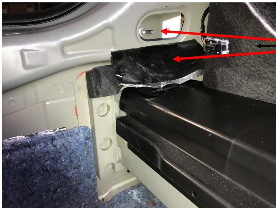
Nehmen Sie auf beide Seiten diese Aluminiumfolie herunter und entfernen die jeweilige Schraube
