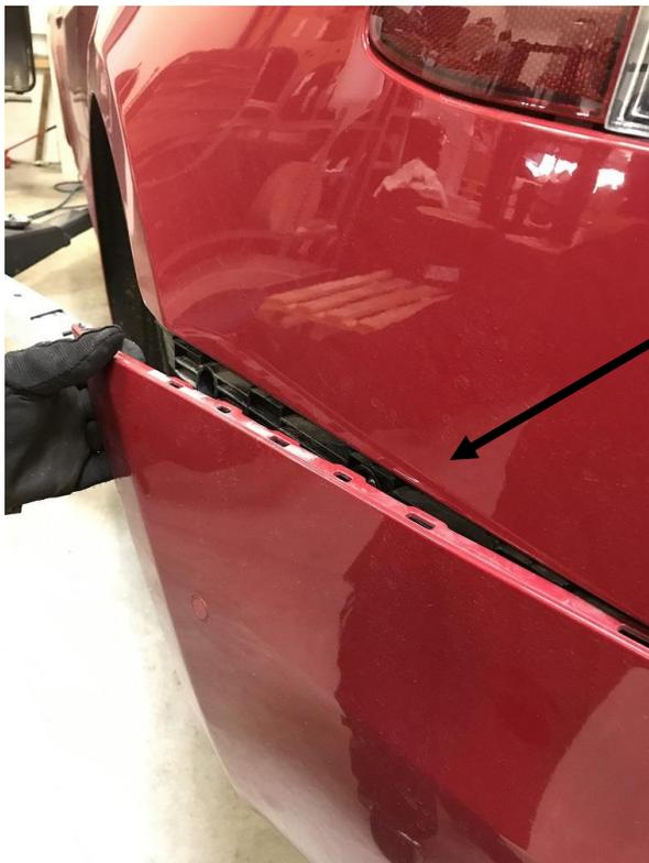
Ziehen Sie die Kotflügel
